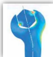
Zones de charge sur les tournevis et les clés de serrage clés.
