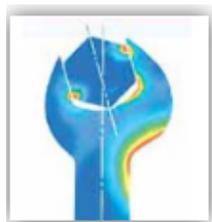
Zones de charge sur les tournevis conventionnels et les écrous.
