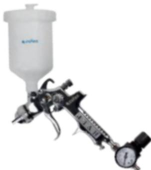
ES Pistola de pintar con regulador aire-pintura en gatillo. Incluye regulador de presión a la entrada de la pistola. Alta transferencia de producto incluso con poca salida de aire. Completamente en acero inoxidable. Es compatible con pinturas al agua.
