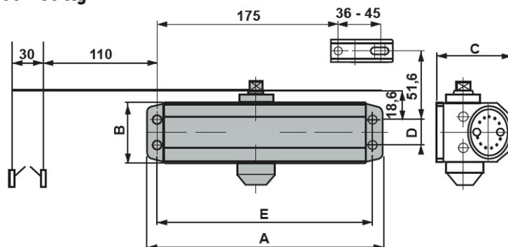
Mola de porta, corpo em Zamack. Braço em aço. Mola em aço lubrificado. Válvulas de regulação com dispositivo termostático. Válvulas de sobrecarga. Modelos para portas de 65 e 85 kg.
