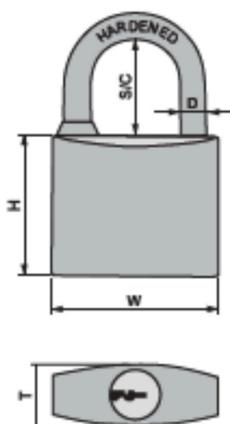
ES Candado fabricado en latón, arco de acero endurecido y anti-corrosivo. Mecanismo de alta seguridad para evitar el robo.
