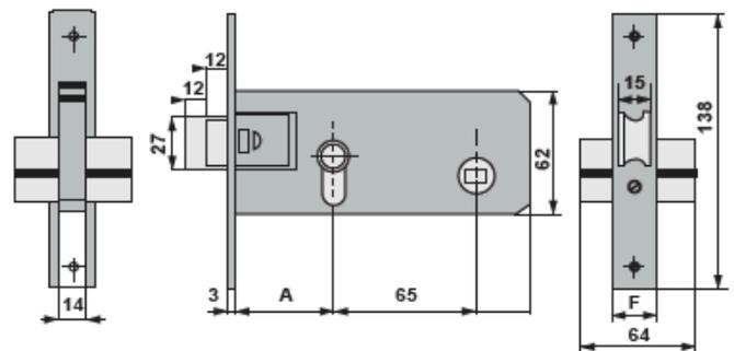
ES Características técnicas: Caja con revestimiento. Frente niquelado. Picaporte reversible niquelado. Contiene tornillo de fijación, cerradura, cerradero y bocallave (escudo).
