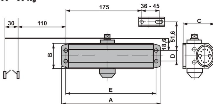
Cierrapuertas, Cuerpo de zamack. Brazo en acero. Muelle en acero lubricado. Válvulas de reglaje con dispositivo termostático. Válvulas de sobrecarga. Modelos para Puertas de 65 y 85 kg.
