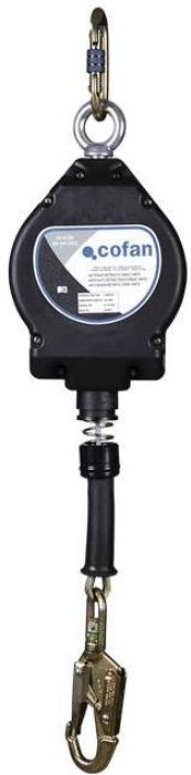
Longitud: 10 m. Diámetro del cable: 4,5 mm Resistencia > 12 kN.
