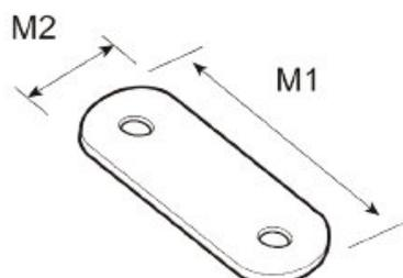
Placa metálica destinada para la unión de 2 paneles. Fabricada en acero zincado de alta calidad. Asegura una unión entre dos paneles fuerte y duradera, proporcionando un soporte estable. Adecuada para armarios, sillas, estantes, camas y cualquier mueble.
