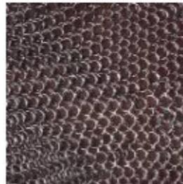
Guante anticorte para carnicero. Está fabricado con una malla metálica de acero inoxidable de muy buena calidad.
