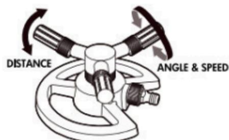
ES Aspersor giratorio de 3 brazos con base estática que le proporciona una mayor estabilidad. Dirección y velocidad ajustables con el aspersor. Fabricado en ABS de alta calidad para una mayor duración.
