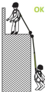
**FACTOR DE CAÍDA 2:** Se puede utilizar en una configuración en la que resulte necesario trabajar por encima del punto de anclaje.
