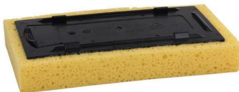
Recambio para liana con esponja en color amarillo. La medida es de 280 x 140 x 30 mm. Se utiliza para trabajos de construcción. Es una herramienta de acabado y los alicatadores la utilizan en la fase final para limpiar adecuadamente las juntas entre baldosas.
